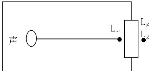
图5.4-1 室内声源等效为室外声源图例
